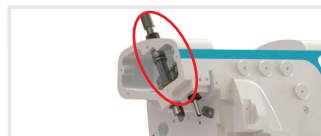
Mecanismo integrado para evitar pérdidas de aceite Motor servo integrado no eixo principal
