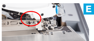
Detector automático de grosor de tela Detector automático da espessura do tecido
